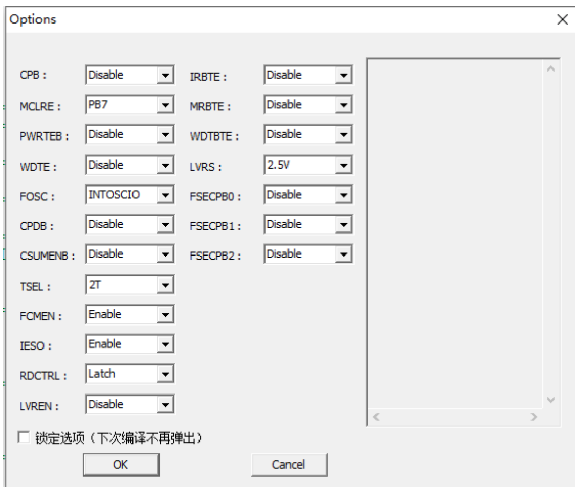
图 17-1 由 IDE 设置的初始化配置寄存器
