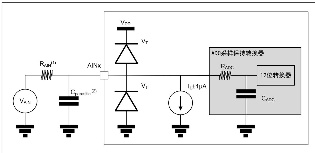
图 6-12 ADC 典型应用连接图
