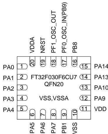
图 4-10 QFN20 引脚分配<sup>6</sup>
