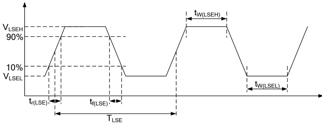
图 6-6 外部低速时钟源交流时序图
