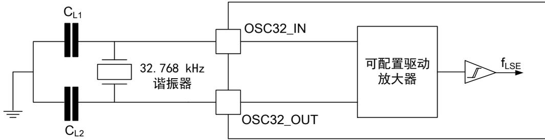
图 6-8 使用 32.768 kHz 晶振的典型应用
