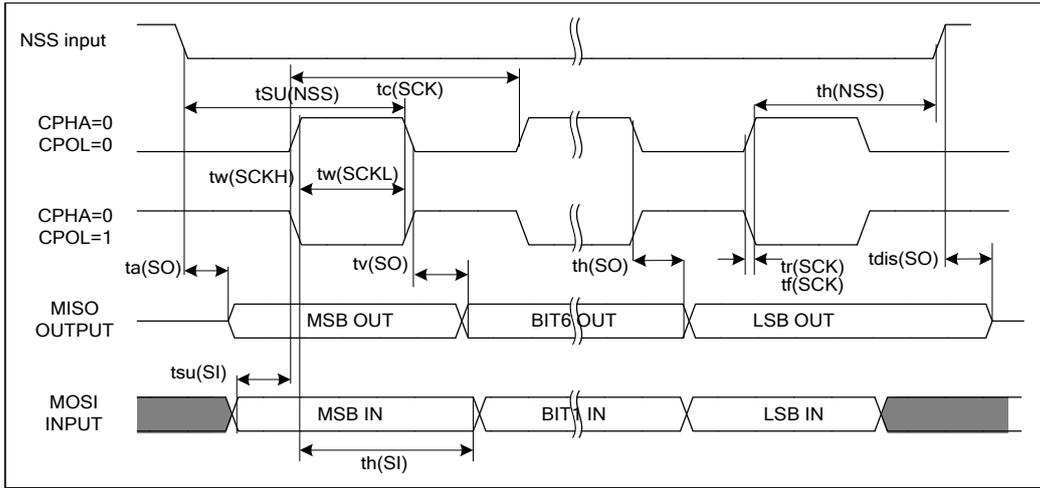
图 6-14 SPI 时序图-从模式并且 CPHA=0
