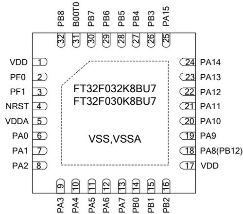
图 4-8 QFN32 引脚分配<sup>5</sup>
