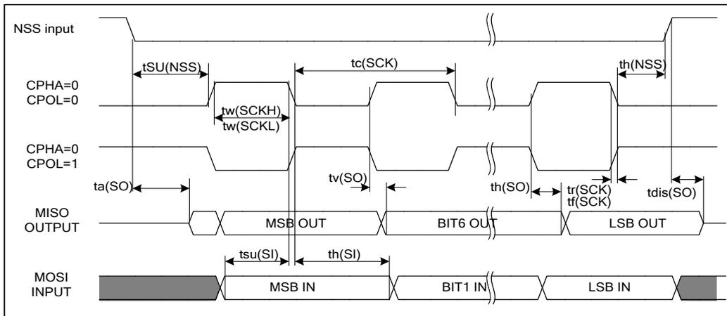
图 6-15 SPI 时序图-从模式并且 CPHA=1
